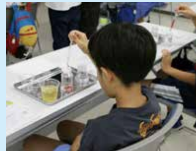
カルシウムを含む水溶液に増粘剤の基となる液体を滴下する実験
